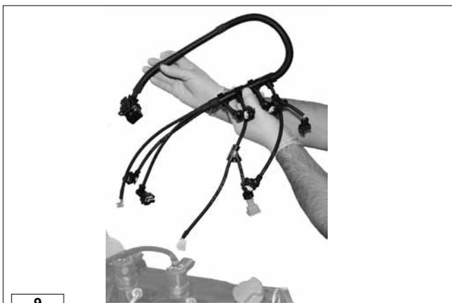
Entfernen Sie den Motor-Kabelbaum.
