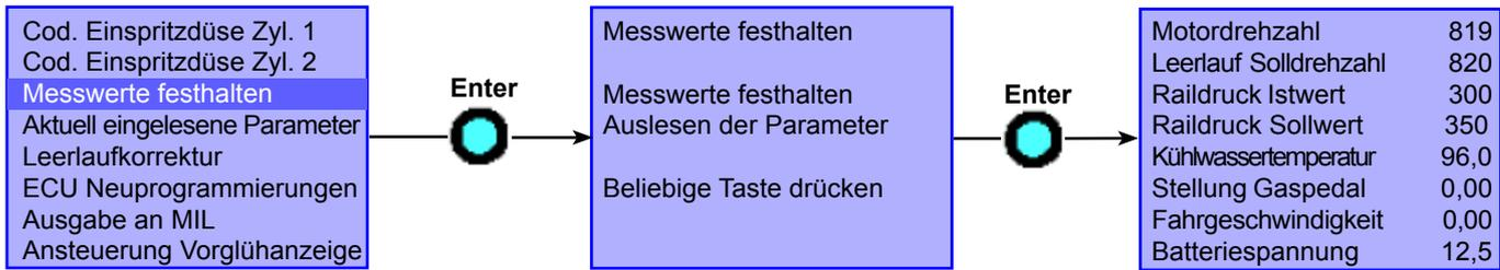
"Messwerte festhalten" erlaubt ein Aufzeichnen der Istwerte zum Fehlerzeitpunkt. Diese Funktion hilft die fehlerauslösende Störquelle einzukreisen.
