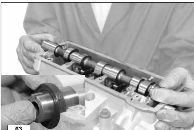
Die Passfeder und den Wellendichtring entfernen.
