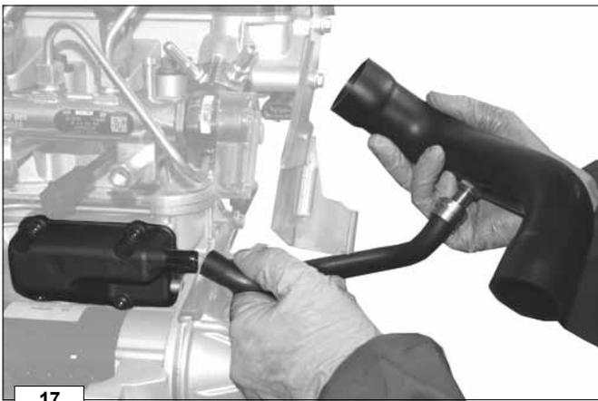
5. Gleichzeitig die Ansaugmuffe und das Rohr der Kurbelgehäuse entlüftung entfernen.
