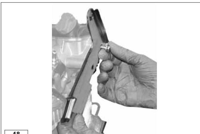
6. Die Befestigungsschrauben entfernen und den Haltebügel des Luftfilters ausbauen.
